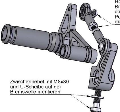
Höhe des Bremshebels über das Bremsgestänges einstellen, dann das Kugelgelenk mit M6x16 am Pedal verschrauben und schließlich die Kontermuttern festziehen
